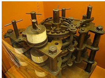
Fig.1 macchina differenziale di Babbage (1822)
